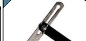
**Угломер-шаблон «Малка».** Для разметки или переноса фиксированного угла с одной поверхности на другую. Материал: сталь, пластиковая ручка.
