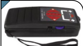
Детектор 3-в-1 Детектор металла, напряжения, балок (в том числе и деревянных) в одном приборе. Поддерживается одновременная работа детекторов металла и балок. Источник питания: батарейка 9 V типа «Крона».
