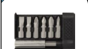
Биты Набор в пластиковом держателе. 6 хром-ванадиевых бит длиной 25 мм + 60 мм адаптер с магнитным фиксатором для быстрой смены бит.
