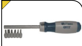
Отвертка телескопическая Со специальным покрытием, увеличивающим срок службы и специальной кнопкой для регулирования длины отвертки (L max =150 мм, L min =70 мм). ABS пластиковая холодостойкая, противударная ручка. В наборе: 6 хром-ванадиевых бит.
