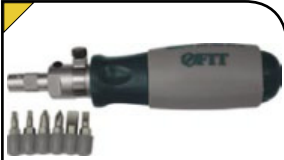
Отвертка реверсивная С усиленным реверсивным механизмом из хром-ванадиевого сплава с матовым покрытием, с кнопкой лёгкого переключения направления. Ручка с отделением для хранения бит. В наборе: 6 хром-ванадиевых бит.
