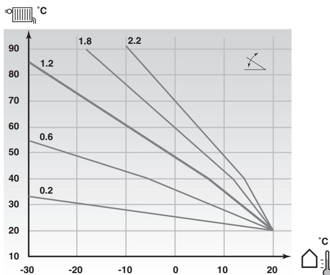
Вы можете задать наклон температурного графика в диапазоне от 0,2 до 2,2. Заводская установка наклона 1,2.
