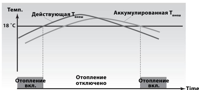
Аккумулярированная  $T_{\text{внеш}}$  символизирует тепло, сохраняемое зданием.
