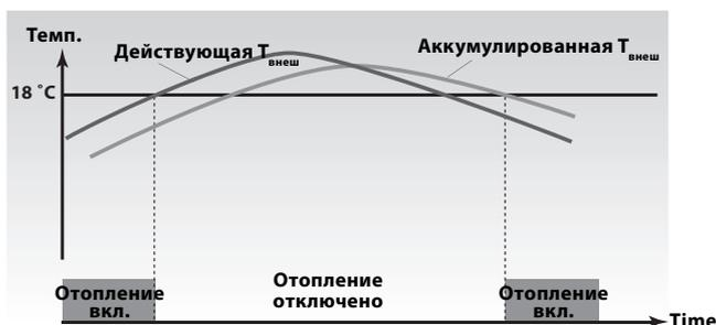
Аккумулярированная  $T_{\text{внеш}}$  символизирует тепло, сохраняемое зданием.
