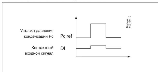
При получении контактного входного сигнала контроллер увеличивает уставку давления, при этом температура конденсации увеличивается, например, на 10 К.
