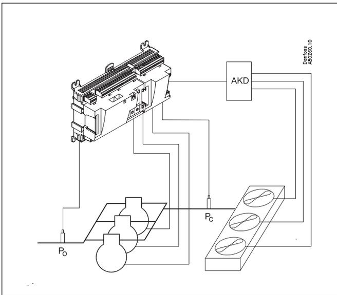
Основной задачей контроллера является управление компрессорами и конденсаторами таким образом, чтобы работа всегда происходила при условиях энергетически оптимального давления. Как давление всасывания, так и давление конденсации, управляются сигналами с преобразователей давления, передающих сигнал напряжения, например типа AKS 32 и AKS 32R.
