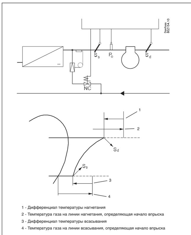
Температура газа на линии нагнетания может быть уменьшена с помощью впрыска жидкости в линию всасывания.
