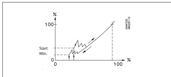
Контроллер запускает преобразователь частоты и первый вентилятор, когда требование производительности соответствует установленной скорости запуска.
