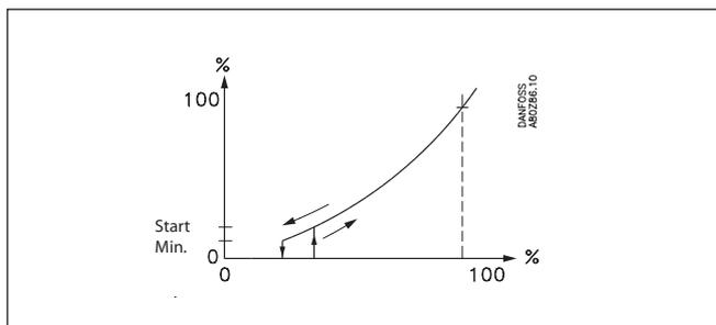
Контроллер останавливает преобразователь частоты, когда требование производительности становится ниже установленной минимальной скорости.
