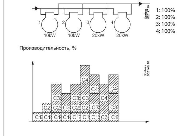
Регулирование производительности компрессора 1 за счет изменения частоты вращения.
