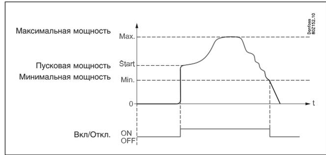
Преобразователь частоты включается при необходимости увеличения производительности компрессоров в соответствии с сигналом «Включить компрессор 1» (на цифровой выход контроллера подается сигнал на включение компрессора, а на аналоговый выход подается напряжение, соответствующее скорости вращения электродвигателя). Преобразователь частоты увеличивает скорость вращения электродвигателя до требуемого уровня.
