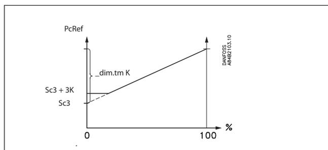
Установите масштабную разницу (dim tm) при максимальной нагрузке (например 15 K).
