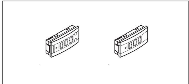
К контроллеру можно подсоединить один или два независимых дисплея. Подсоединение осуществляется при помощи кабеля со штекерным разъемом. Дисплей можно установить на щите управления.
