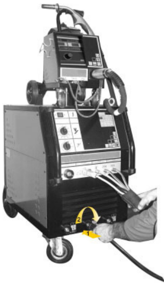
6 – Подключите кабель «земля» к разъёму «-» источника питания и заготовке, проверьте правильность электрического контакта зажима «земля» с заготовкой.
