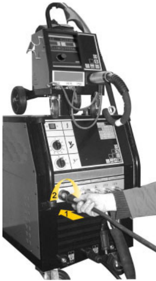
4 – Подключите силовой кабель электрододержателя Argair к разъёму «+» источника питания.
