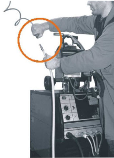
5 - Подключите воздушный шланг электрододержателя Argair к системе подачи сжатого воздуха. Минимальное давление сжатого воздуха 5 бар, минимальный расход 100 л/мин.
