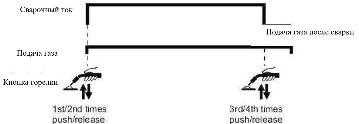
Рис. 11. Режим управления горелки 4 такта (1/2 такты: нажатие; 3/4 такты: отпущание)
