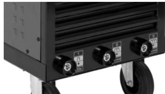
3 inductance positions MIG 350C / MIG 400C
