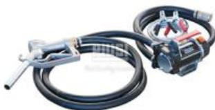
Переносной узел для перекачивания дизельного топлива. Самовсасывающий крыльчатый электронасос с двигателем 12 или 24 В постоянного тока. Чугунный корпус. Щеточный двигатель со статором с постоянными магнитами. Высота всасывания до 2 метров. Клеммная колодка с выключателем и предохранителем для защиты от перегрузок. Кабели длиной 2 метра с зажимами для соединения с аккумулятором. Труба длиной 4 метра для топлива, диаметр 3/4". Ручной пистолет из алюминия. Донный фильтр для всасывающей трубы.
