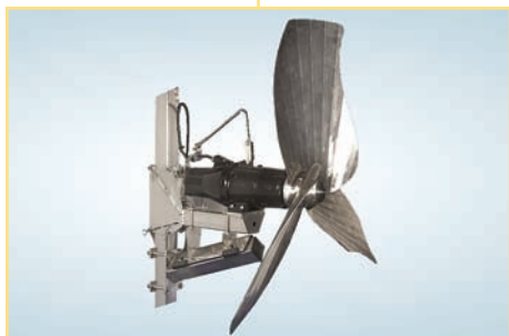
Конструкция из чугуна 4- и 6-полюсные двигатели мощностью от 0,75 до 5,5 кВт с планетарным редуктором Лопастей Ø 620-2100 мм. От 27 до 148 об./мин.
