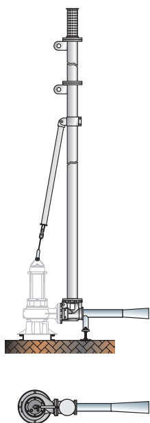
OXY ШВ0/100 Мембрана Ш55/63 мм Корпус эжектора DN 80/100 Труба для всасывания воздуха Ш100
